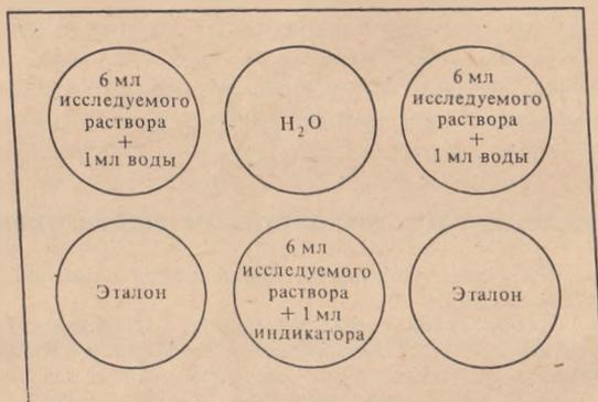
Рис. 4. Схема расположения пробирок в компараторе при определении рН окрашенных и мутных жидкостей
