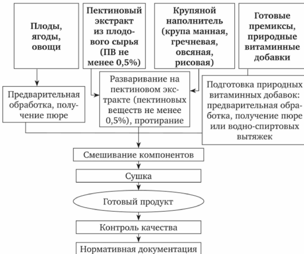
Рис. 2.16. Технологическая схема получения сухих пектиносодержащих продуктов функционального назначения
