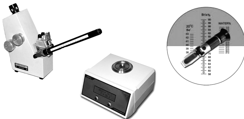
Рис. 56. Рефрактометр ИФР 454 2ВМ, рефрактометр портативный и увеличенная шкала, рефрактометр цифровой АЛР-3
