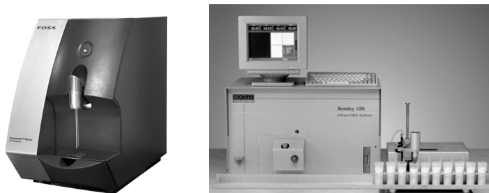
Рис. 39. Цитометры для определения количества соматических клеток в молоке «Foss somatic minor», «Beantley Somacount 150»
