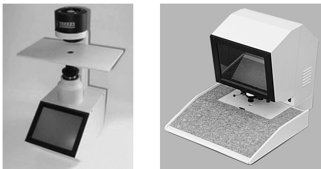
Рис. 10. Проекционные трихинеллоскопы «Стейк», «Стейк-про»
