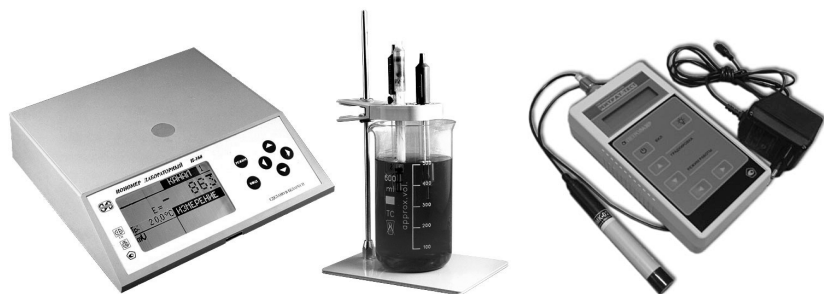
Рис. 58. Универсальный иономер «И-160» и нитратомер «Нитрат-тест»
