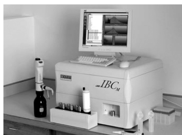
Рис. 37. Цитометры поточного действия для определения микробной обсемененности молока «VactoScan FC», «Bentley BakctoCount IBC»
