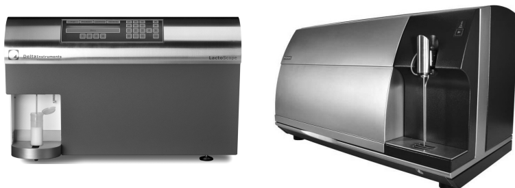
Рис 33. Инфракрасные автоматические анализаторы молока «LactoSkop C4», «MilkoScan FT2»
