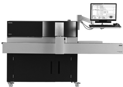
Рис. 37. Цитометры поточного действия для определения микробной обсемененности молока «VactoScan FC», «Bentley BakctoCount IBC»
