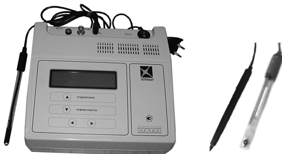
Рис. 24. pH-метр «Статус» и комбинированные электроды для определения кислотности молока и сыра
