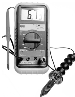
Рис. 17. Цифровой рН-метр «Статус-2» и штывковой электрод для определения рН мяса
