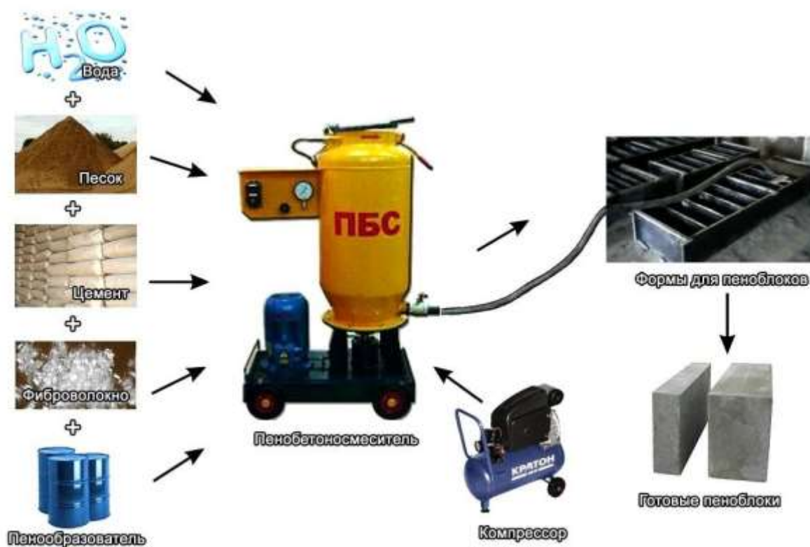
7.2-rasm. Koʻpik beton ishlab chiqarish texnologiyasi.
