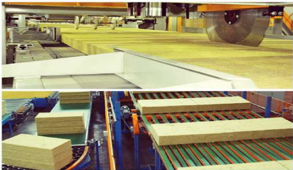
3.9-rasm. Mineral paxta ishlab chiqarish texnologiyasi
