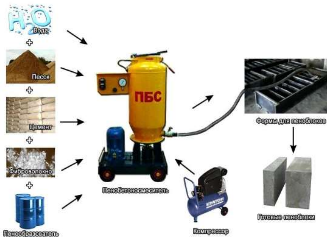
Рисунок 7.2. Технология производства пенобетона.
