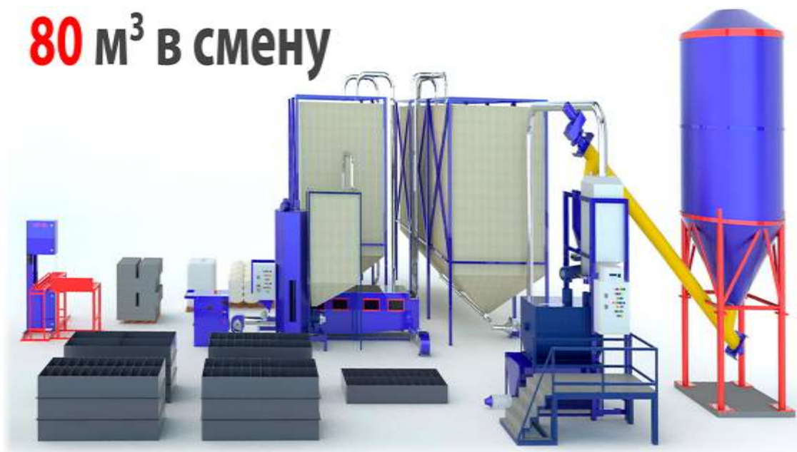
Рисунок 7.9. Линия по производству полистиролбетона 80 м 3 за 1 смену
