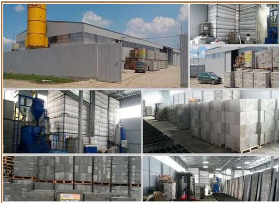
Рисунок 7.6. Завод по производству пенополистиролбетонных блоков.
