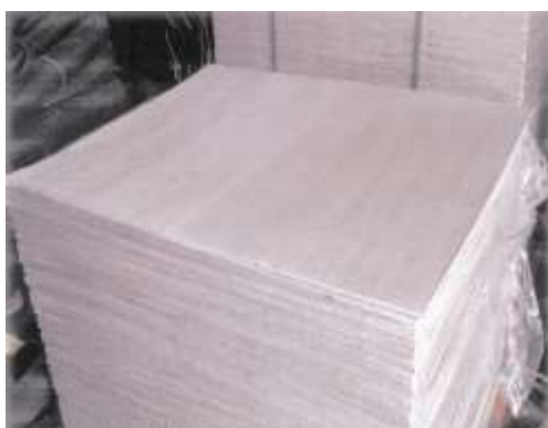
Картон асбестовый для теплоизоляции труб с рабочей температурой до 500°C и защиты древесины и легковоспламеняющихся предметов.
