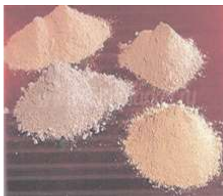
Асбесто-магние́вый порошок для теплоизоляции промышленного оборудования до 350°C.
