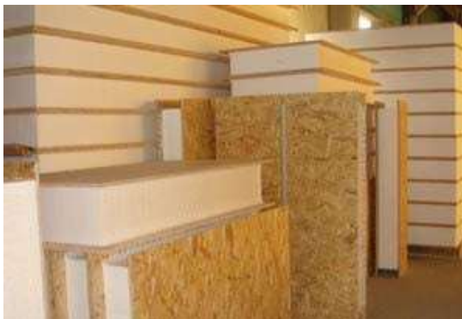
17-rasm. Qalinligi 124 mm dan ortiq bo‘lgan SIP-panellar
