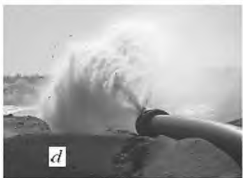
2.39-rasm. Loyqasoʻrgich snaryadining ishlash jarayoni: a -umumiy koʻrinishi; b -transport quvurining umumiy koʻrinishi; c, d -aralashmani otish jarayoni; e -frezali ish jihozi va soʻruvchi kallakning koʻrinishi.
