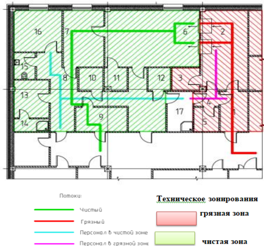
Рис. 88. Пример планировочного решения и технологического зонирования прачечной.
