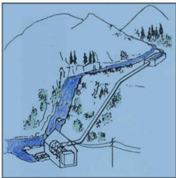
a – derivatsion (suvni asosiy o‘zandan tarmoqlab olish)
