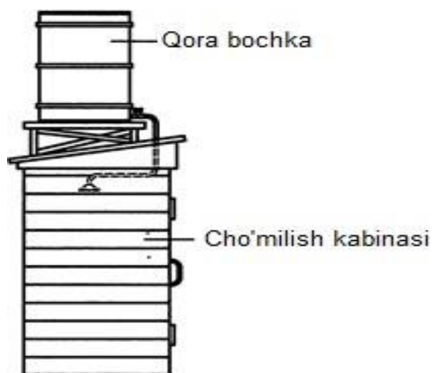
5.18-rasm. «Bochka» tipdagi quyosh kollektori
