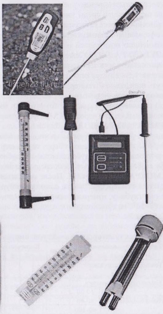
**Рисунок 11. Термометры и психрометры разных моделей, измеряющие температуру помещения, воды и почвы.**
