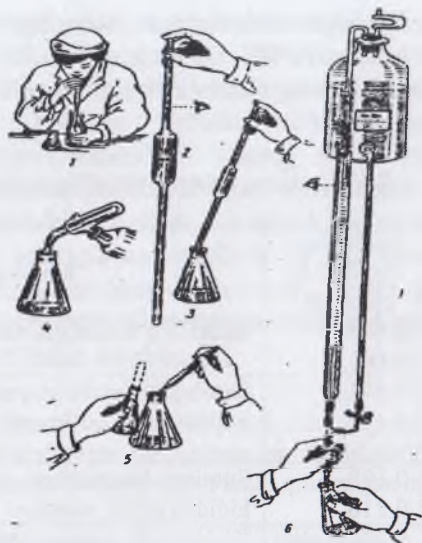
16-rasm. Sutni titrlash yuli bilan kislotaliligini aniqlash:
