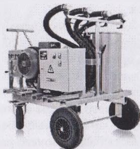
*Рис.13. Аэрозольный генератор «ИГЕБА»*
