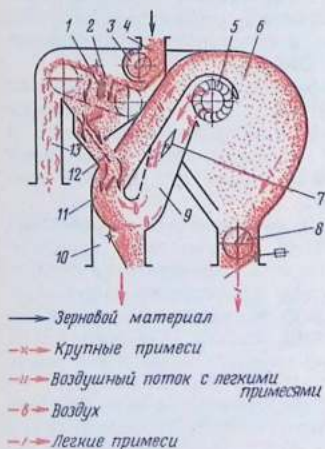
Рис. 159. Схема машины предварительной очистки зерна МПО-50:
