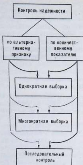
Рис. 54. Структурная схема контроля надежности.
