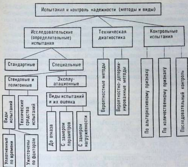
Рис. 46. Классификация методов испытания и контроля надежности.
