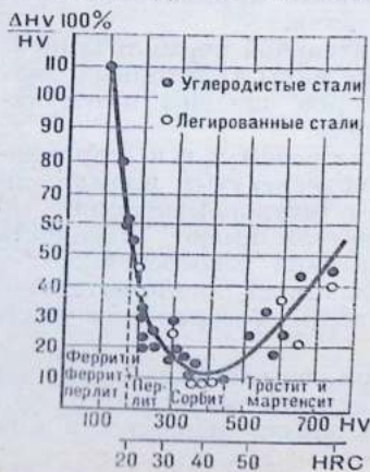
Рис. 58. Величина упрочнения \frac{\Delta HV}{HV} % при поверхностном пластическом деформировании углеродистых и легированных сталей в различных структурных состояниях при степени деформации \frac{d}{D} = 0,5 .
