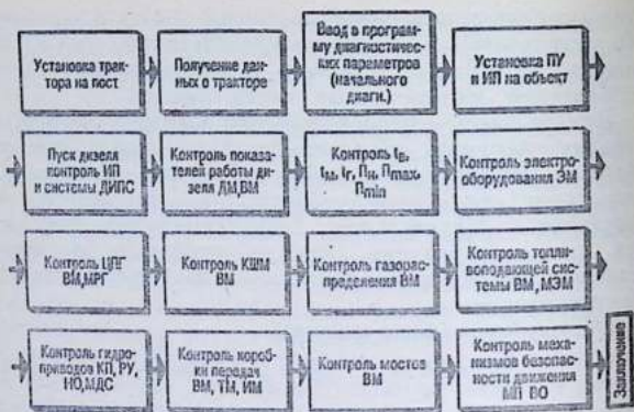
Рис. 6.11. Общая схема технологии диагностирования тракторов и сложных сельскохозяйственных машин ДИПС:
