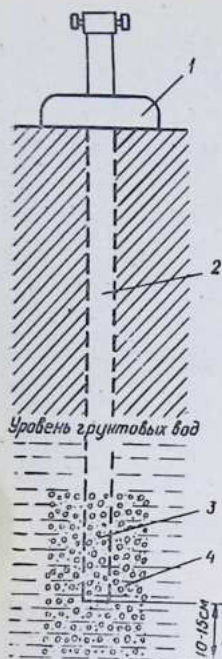
Рис. 29. Скважина для наблюдений за уровнем залегания грунтовых вод:
