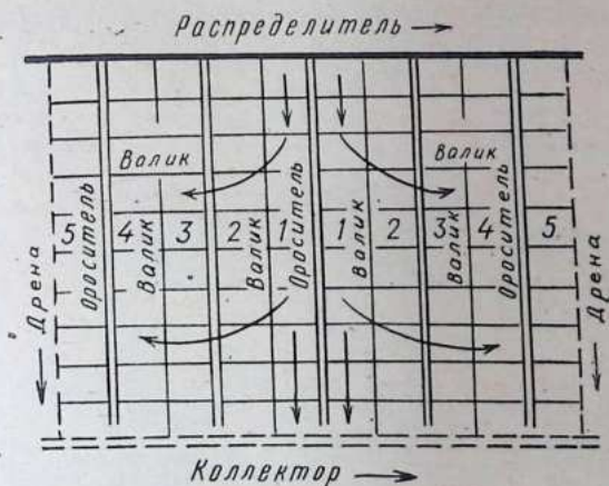
Рис. 56. Очередность промывки (1, 2, 3, 4, 5) и направление оттока солей к дренам и коллектору
