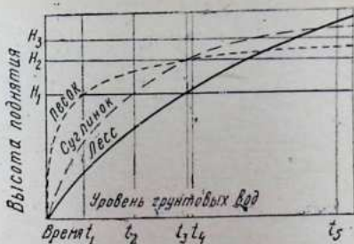
Рис. 28. Схематические кривые капиллярного подъема грунтовой воды разными грунтами (по С. И. Тюремову)
