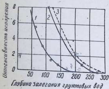
Рис. 6. Зависимость интенсивности испарения грунтовых вод от глубины их залегания (по В. А. Ковда):
