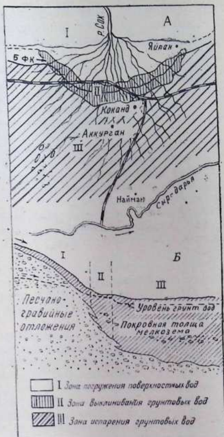
Рис. 4. Гидрогеологические зоны земель системы р. Сох (А — план; Б — в разрез)
