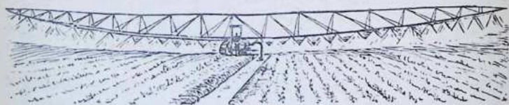
Рис. 49. Двухконсольный дождевательный аппарат ДДА-100М (расход воды 100 л/сек)
