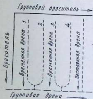
Рис. 69. Расположение временных мелких и постоянных глубоких дрен
