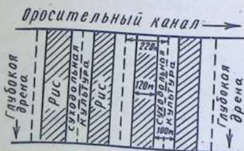
Рис. 91. Схема расположения посевов при двухтактной форсированной промывке
