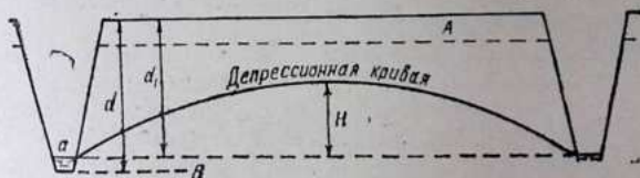
Рис. 64. Влияние дренажа на грунтовые воды:
