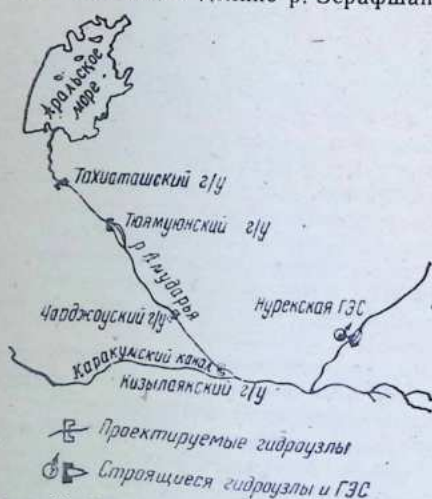
Рис. 86. Схема расположения строящихся и проектируемых гидроузлов на р. Амударье
