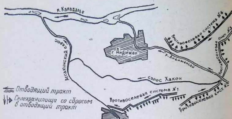
Рис. 103. Схема противоселевых сооружений у гор. Андижана
