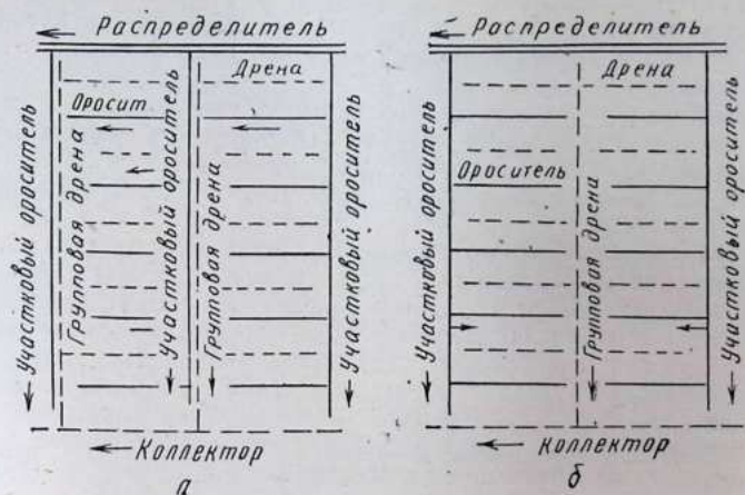
Рис. 67. Расположение оросительной и коллекторно-дренажной сети при одностороннем (а) и двустороннем (б) командовании участковых оросителей
