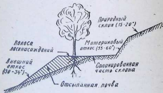
Рис. 99. Профиль террасы, построенной грейдером Д-20А
