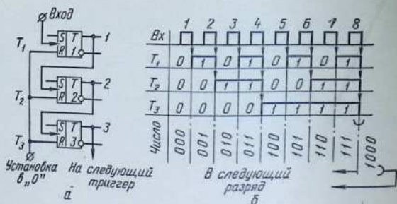
Рис. 53. Счетчик импульсов: а — схема; б — временная диаграмма работы.
