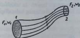
10.3-rasm. Zichligi o'zgar- maydigan suyuqlikning o'z- garuvchan kesimli trubkadan oqish sxemasi
