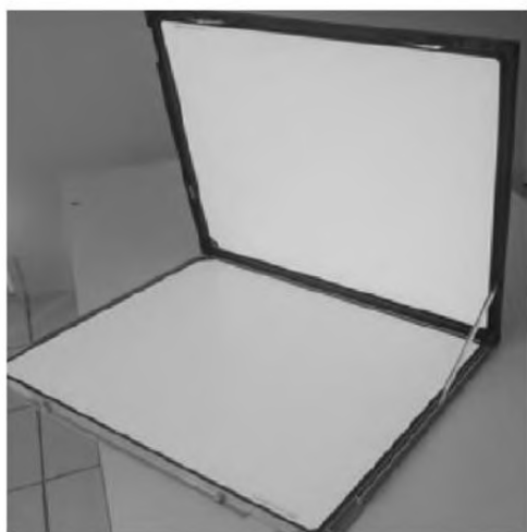
16. Rasm Ikki kuchaytiruvchi ekran (3) orasiga joylashtirilgan kasseta (1) va rentgen plyonkasi (2)
