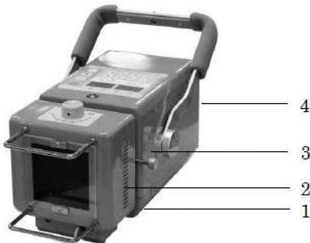
1 - korpus, 2 - kollimator, 3 - ionlashtiruvchi nurlanish manbai, 4 - shtativga o'rnatish dastagi
