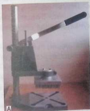
8.11-расм. Сунъий мумкатак кассеталаридан пергани чиқариб олиш қўл пресси
