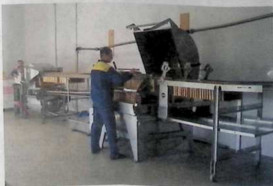
7.5-расм. Асални автоматлаштирилган линияда ҳайдаб олиш (АПИС Украина фирмаси)
