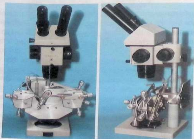
9.27-расм. Она асалариларнинг қин тешиги соҳасига сперма сунъий киритилиши учун ниш ва вентрал илгаклари блоклари такомиллаштирилган қурилма
