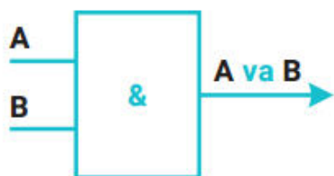
1-rasm. "VA" mantiqiy elementi
