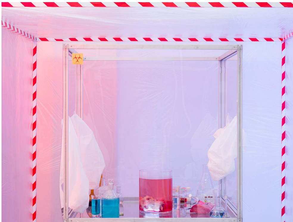
Рисунок №2. Биологические перчаточные камеры.
