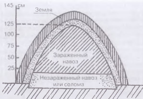
Рис. 32. Биотермическое обеззараживание навоза
