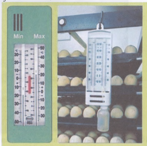
10.2-rasm. Harorat va namlikni nazorat qilish uchun o'rnatilgan psixrometr.
