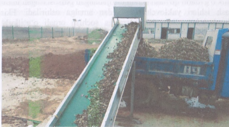
11.3-rasm. Lentali transporter yordamida axlatni chiqarish jarayoni.
