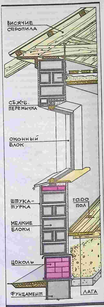
31. Стена из легкобетонных камней
