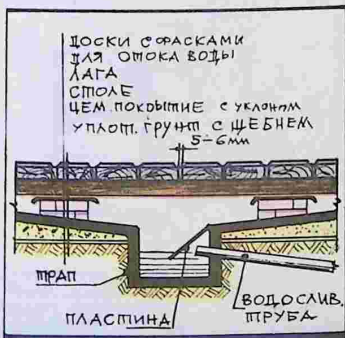
93. Фильтрующая траншея
