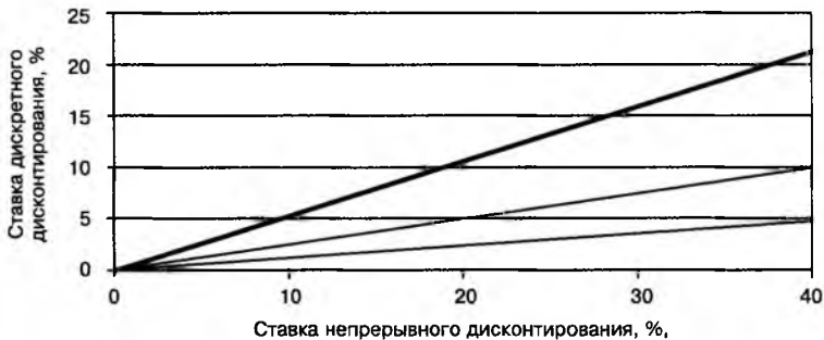
Рис. 11.3. Эквивалентные по сегодняшней стоимости ставки дисконтирования будущих денежных потоков; сверху вниз: за первый, второй и третий периоды
