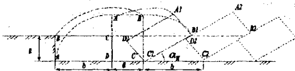
7-rasm. Tuproq palaxsasini ag'darilish sxemasi
