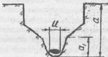
14-rasm. Sirpang'ichli ekkich ochadigan ariqchanning ko'ndalang kesimi
