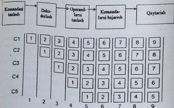
1.9-chizma. 5 bosqichdan iborat konveyer (a); o'tilgan sikllarning miqdoriga bog'liq holda har bir bosqich holati (b). 9 ta sikl ko'rsatilgan
