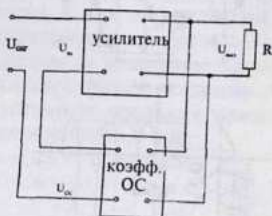
Рис. 19.7. Отрицательная обратная связь в усилителях.
