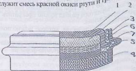
Рис. 3.14. Ртутно-цинковый элемент: 1-крышка; 2-отрицательный электрод; 3-корпус; 4-положительный электрод; 5-резиновое кольцо; 6-бумажный сепаратор; 7-бумажная диафрагма.
