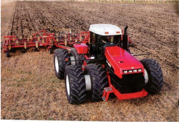
7-rasm. VERSATILE rusumidagi Tuproqqa ishlov beruvchi universal chizel-kultivatori. Ushbu agregat ekinlardan bo'shagan yerlarda, Shuningdek aniz dalalarni 25-30 sm yumshatishga mo'ljallangan.
