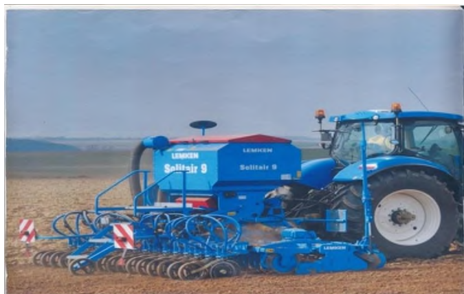
9-rasm. LEMKEN kompaniyasining Zirkon 10KA rusumidagi rotatsion borana hamda Solitair-9K rusumidagi kombinatsiyalashgan seyalkasi.
