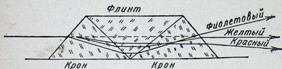
Рис. 59. Ход лучей в спектроскопе прямого зрения.
