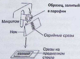
Рисунок 97 – Принцип работы ротационного микротомов
