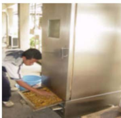
65 - rasm. Kichik sexlarda qo'llaniladigan dudlash uskunasi.(daraxt qirindillari pastki latok qismiga qo'y iladi).
