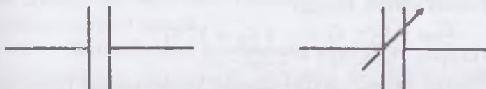
102-rasm. Kondensatorlar. a) O'zgarmas sig'imli kondensator va b) o'zgaruvchan sig'imli kondensator.
