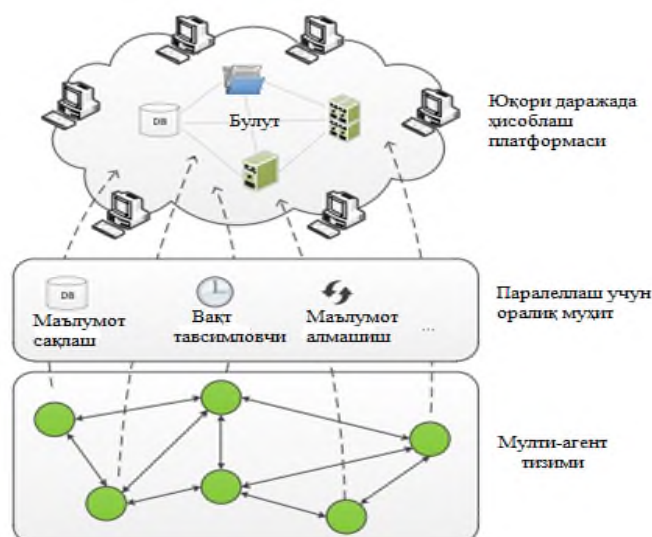
2.9-rasm. Multi-agent tizimi bilan bulutli hisoblash tizimi integratsiyasi.
