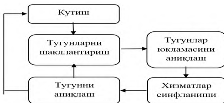
2.10-yuklamani balanslovchi agentning ishlash algoritmi.
