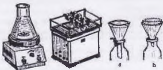
6-rasm. Elektromagnitli aralashtirgich asbobi va qog'oz filtr orqali filtrlash:
