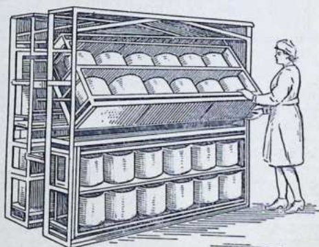
Рис. 76. Секция передвижного этажера с переворачивающимися полками для голландского сыра.
