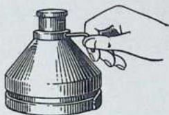
Рис. 32. Регулирование жирности сливок при помощи сливочного винта.
