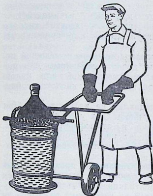
Рис. 32. Перемещение бутылей с кислотами или щелочами
