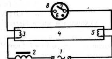
4.3.3-расм. Люминцент лампанинг уланиш схемаси: 1-ток манбаи; 2-дроссел; 3,5-лампа электроди (накал); 4-трубка; 6,7-стартёр электродлари; 8-стартёр
