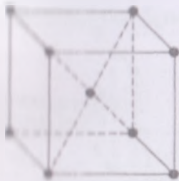
1.6.a-rasm. Hajmi markazlashgan kub kristall katakcha.
