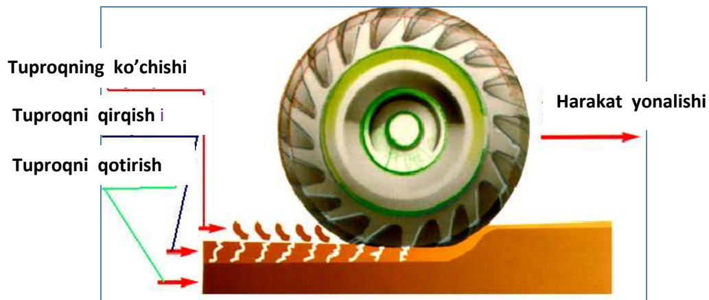
10-rasm. Traktor g'ildiraklarini shataksirash jarayoni
