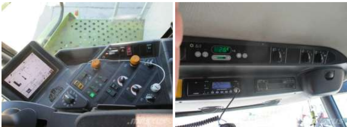
94-rasm. Klaas kompaniyasi “Lexion” kombaynini bort kopyuteri
