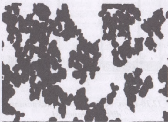
12.11-rasm. Volfram karbidi kukunining standart (a) va tiklangan UDK (b) asosidagi elektron-mikroskopik ko'rinishlari UDP (b) \times 50000 .
