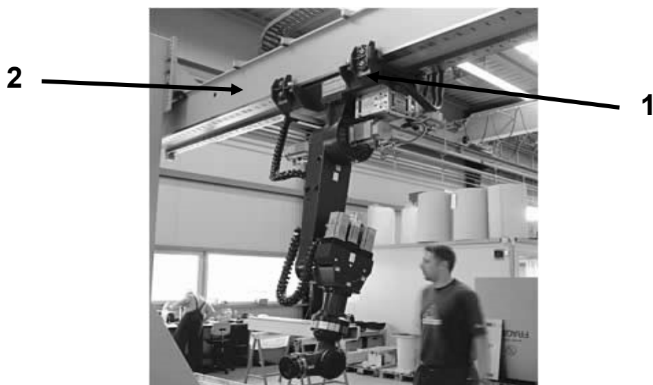
Рис.2.17. Транспортный промышленный робот ТРТ1-250. 1 – тележка, 2 – монорельс.
