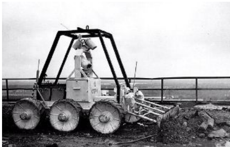
Рис.2.16. Специализированный транспортный робот СТР-1 на колесном ходу
