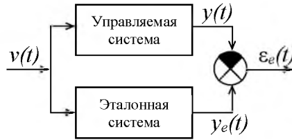
Рис. 1.46. Сравнение управляемой системы с эталонной
