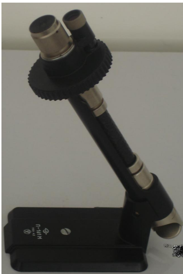
Расм 2.16. П-161М русумли лаборатория поляриметри
