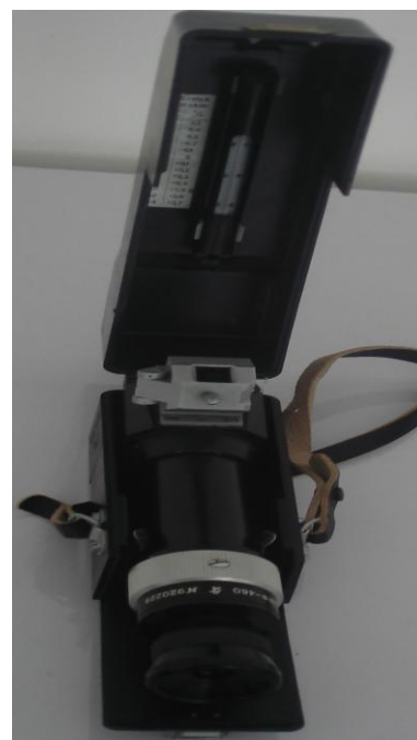
Расм 2.24 ИРФ-464 русумли кўчма рефрактометр
