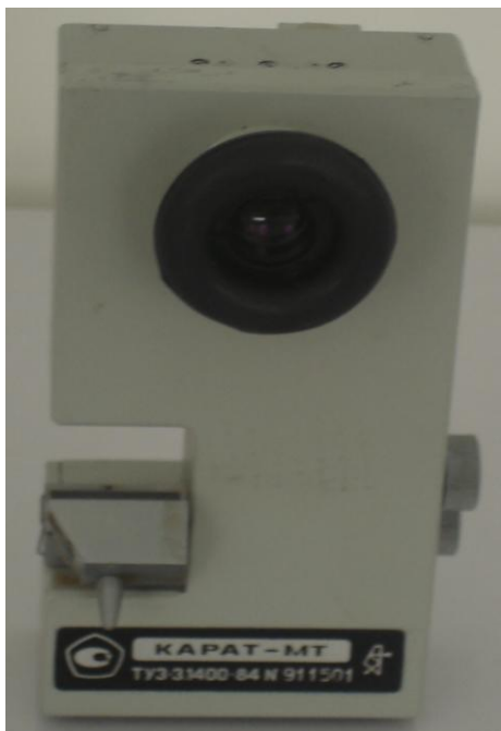
Расм-2.23. КАРАТ-МТ русумли кўчма рефрактометр
