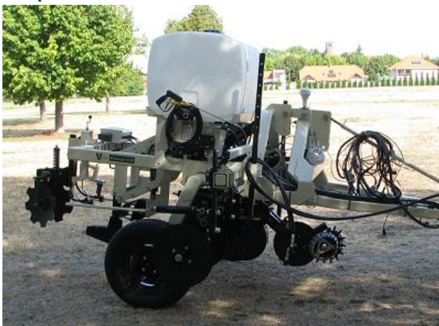
Рис. 7.10. Мобильный анализатор свойств почвы от компании Veris Technologies с системой навигации Garmin
