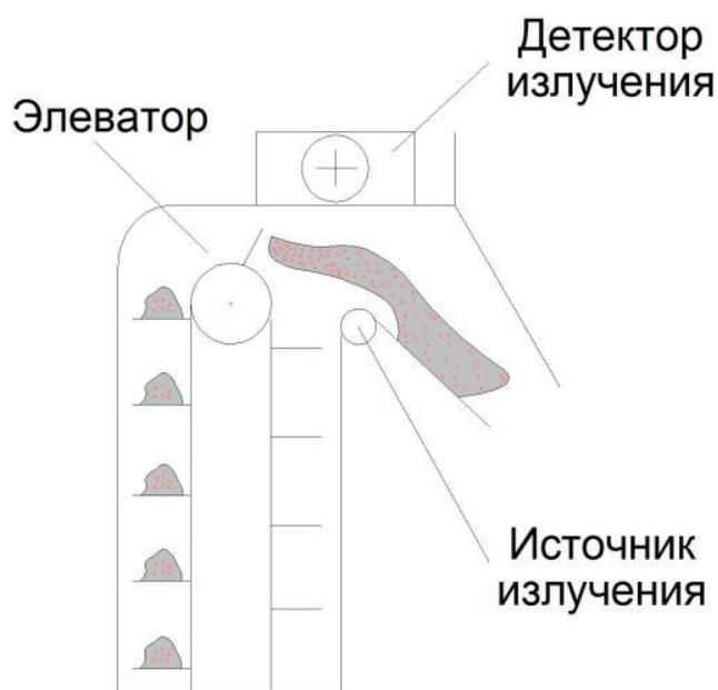
Рисунок 9.12 – Схема косвенного определения прохода зерна в зерновом элеваторе с помощью измерения гамма-лучей радиоактивного элемента в радиодетекторе
