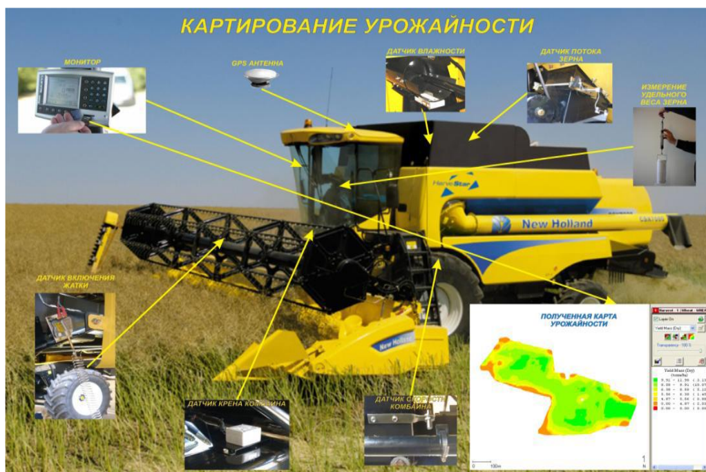
Рисунок 8.3 – Расположение приборов системы картирования урожайности на зерноуборочном комбайне и получаемая карта урожайности
