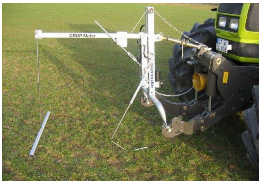
Рисунок 9.9 – Общий вид смонтированного на тракторе датчика Crop Meter
