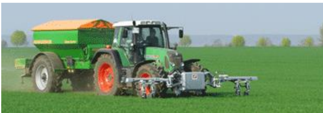
Рисунок 9.7 – Датчиковая система для определения доз азота MiniVeg N
