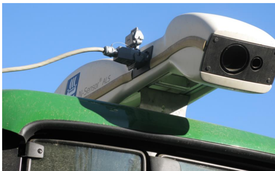
Рис. 10.4 Сканирующая система Yara N-Sensor ® ALS, установленная на кабине трактора
