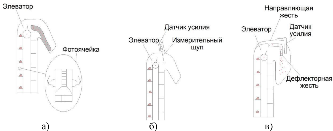
Рисунок 9.11 – Схема измерения объема проходящего зерна в элеваторе:
