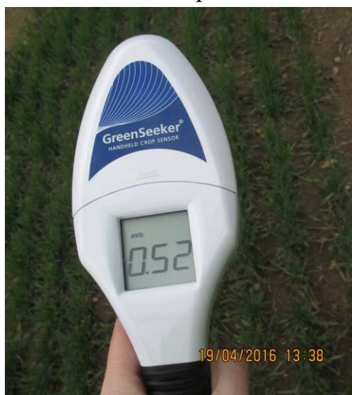
Рис. 9.19. Оптический датчик GreenSeeker handheld, ручные измерения NDVI посева.
