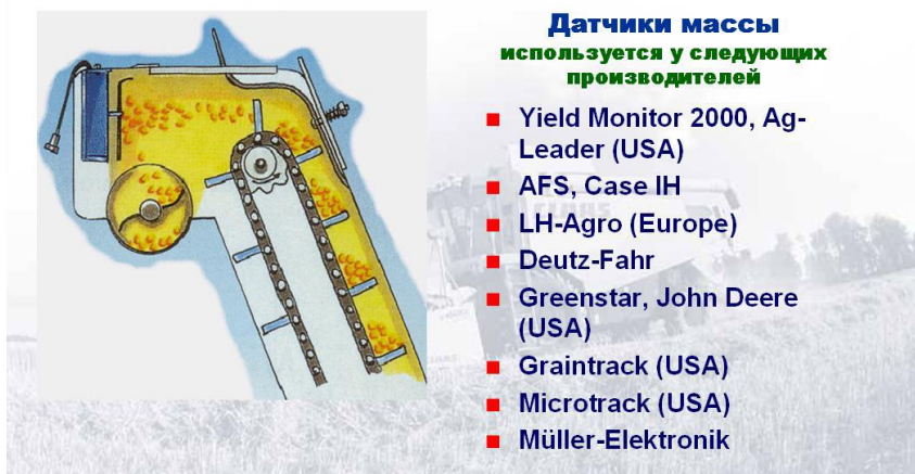
Рисунок 8.7 - Схема расположения сенсора силы удара в элеваторе бункера зерноуборочного комбайна
