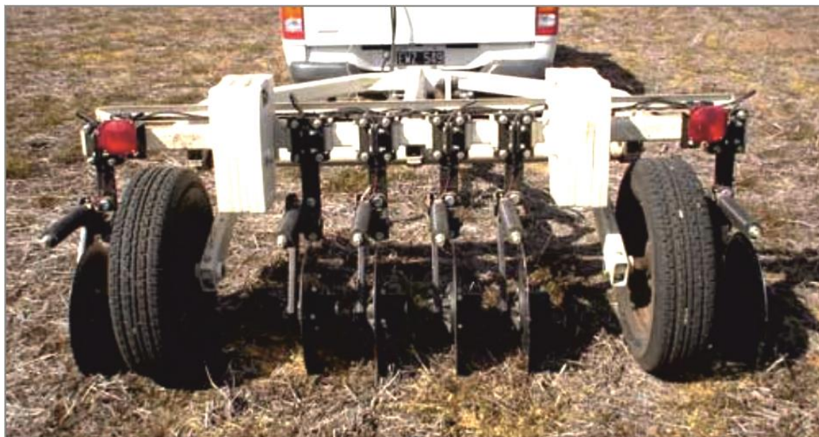
Рис. 7.17 Картирование электропроводности почвы с помощью прицепного агрегата Veris 3100 (компания «Veris Technologies», США)
