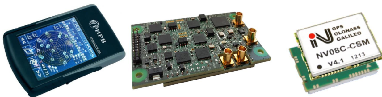
Рис. 2.3 Типы навигационных приемников (устройство, плата, модуль).
