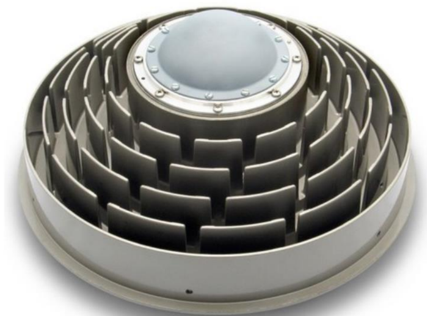
Рис. 2.5 Choke Ring антенна со снятым защитным кожухом
