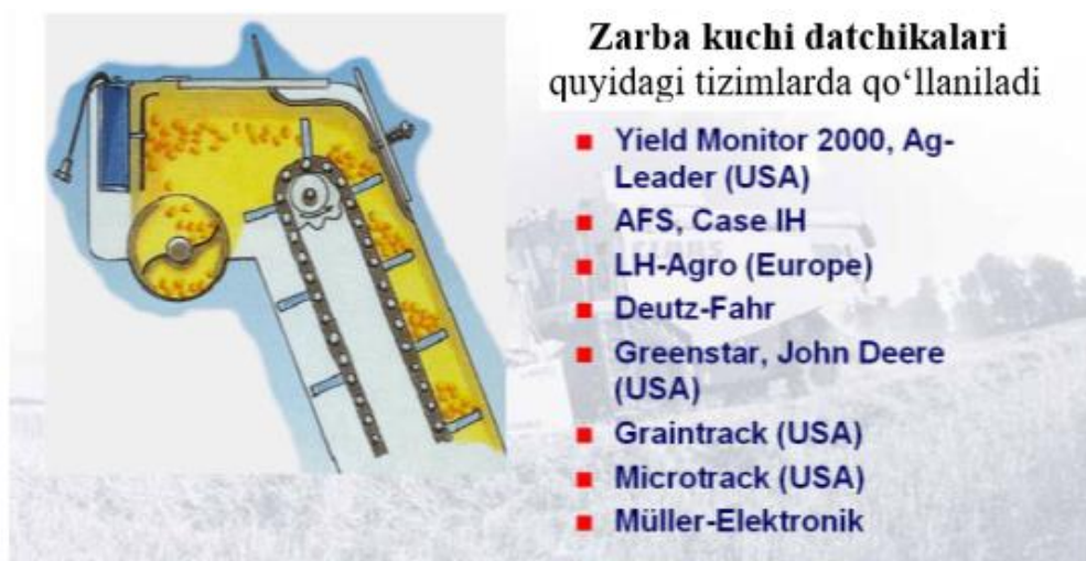
9.7-rasm. G'alla kombayni bunkeridagi elevatorga don oqimi zarba kuchini sezuvchi datchikni joylashish sxemasi
