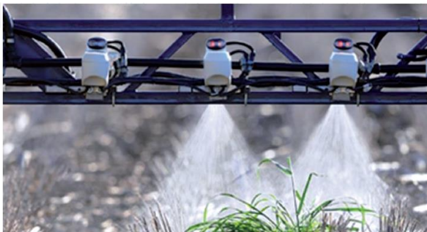
7.16-rasm. WeedSeeker tizimi bilan begona o‘tlarga tanlab ishlov berish
