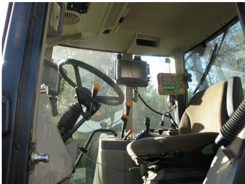
7.1-rasm. O‘g‘itni tabaqalashtirib sepishda traktor kabinasiga o‘rnatilgan bort-kompyuteri va kontroller
