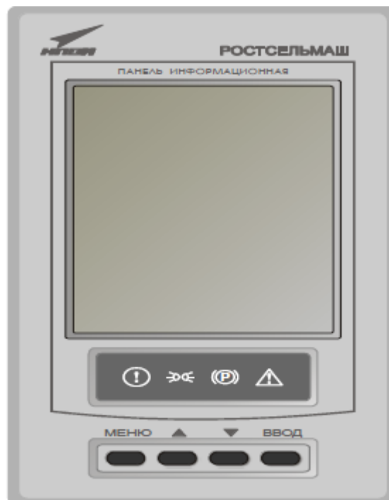
9.2-rasm. Hosildorlikni davriy ravishda aniqlab borish uchun kombayn kabinasiga o'rnatilgan displey
