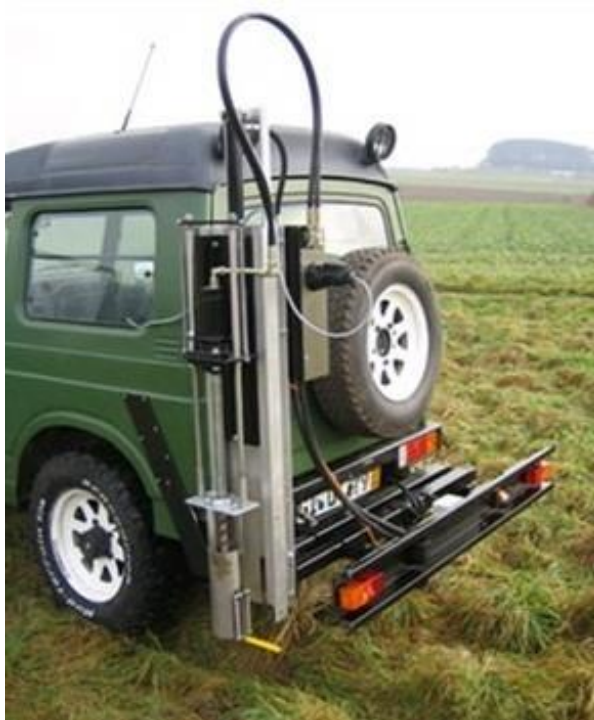
6.8-rasm. N 2000 («Bodenprobetechnik Nietfeld») tuproqdan avtomatik namuna olgich
