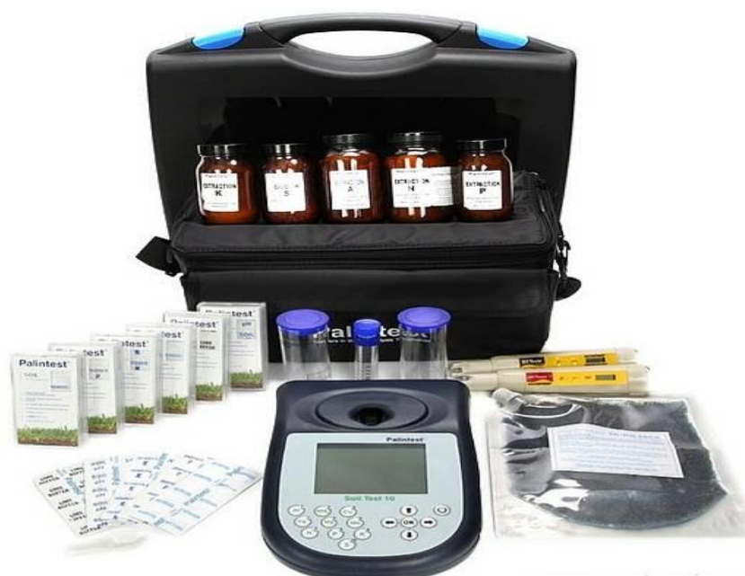
6.10-rasm. Portativ agrokimyoviy tahlil laboratoriyasi
