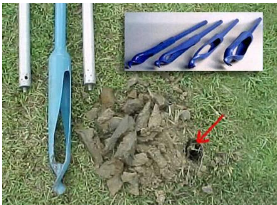
6.1-rasm. Har xil uchliklarga ega qo'l tuproq namunaolgichlari
