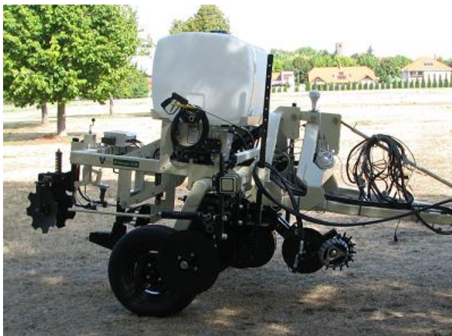
6.9-rasm. Veris Technologies kompaniyasining Garmin navigatsiya tizimi bilan jihozlangan tirkama analizator kompleksi
