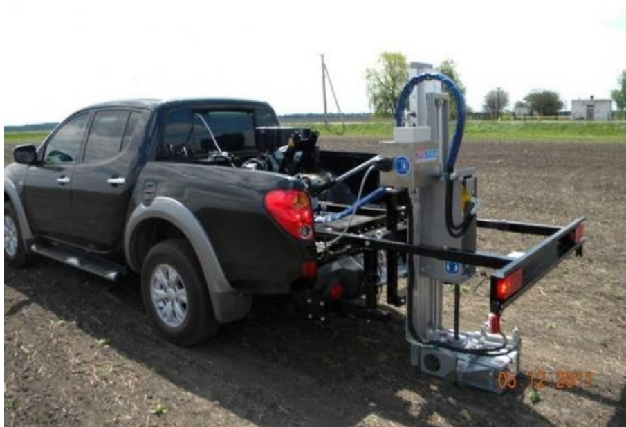
6.7-rasm. Aniq qishloq xoʻjaligidagi koʻchma tuproq laboratoriyasi
