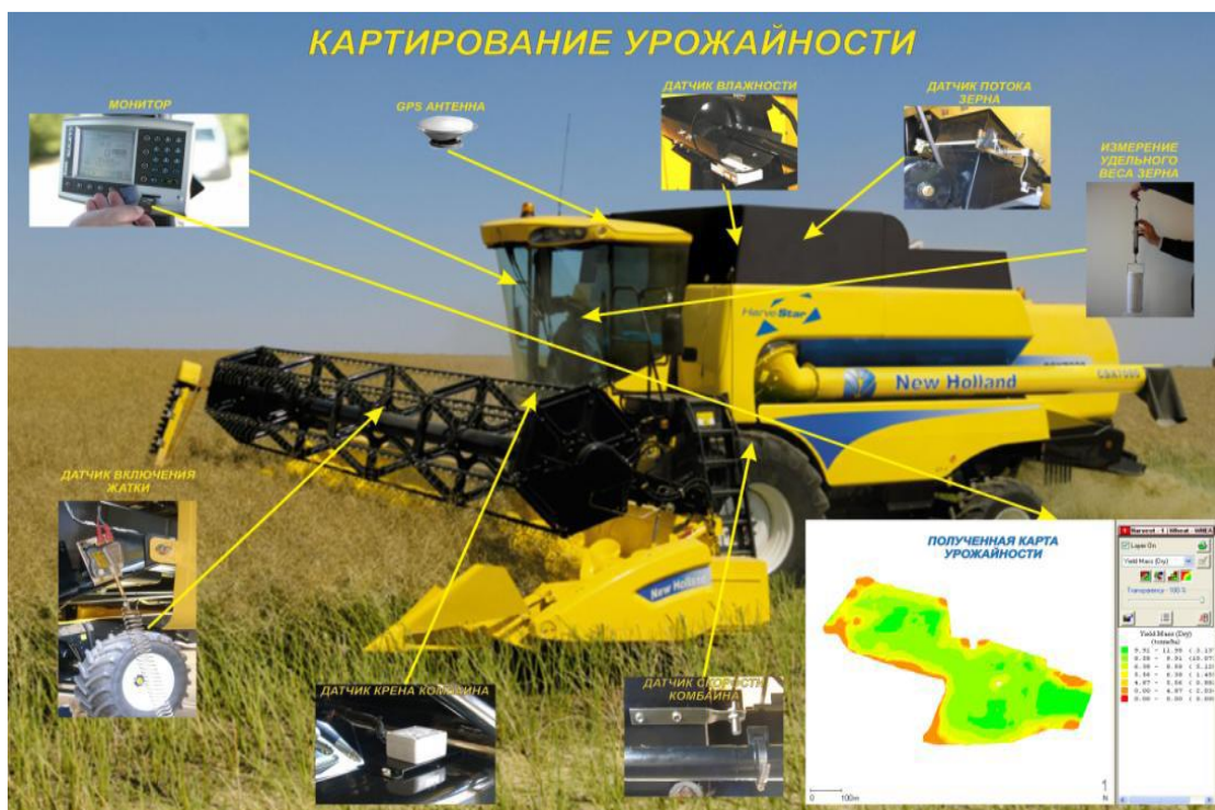
9.3-rasm. Kombaynda hosildorlikni xaritalash tizimi asboblarning joylashishi va olingan hosildorlik haritasi
