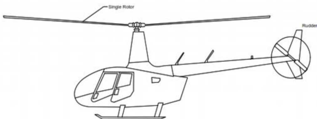
10.8-rasm. Bir (yakka) rotorli uchuvchisiz uchish vositasi konstruktsiyasi
