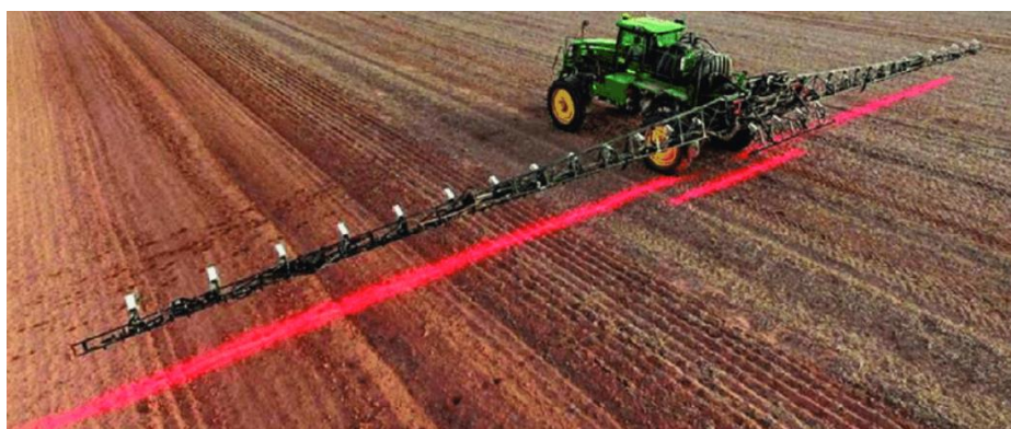
7.14-rasm. WEED-IT tizimida infraqizil datchiklar bilan begona o'tlarni aniqlash va dori sepish
