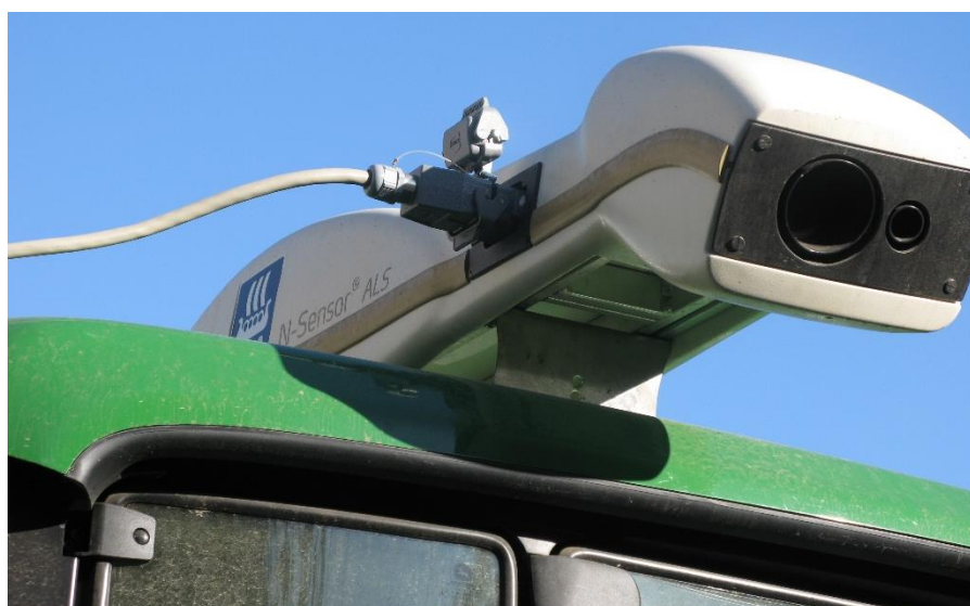
7.4-rasm. Traktor kabinasiga o'rnatilgan Yara N-Sensor ALS skaneri
