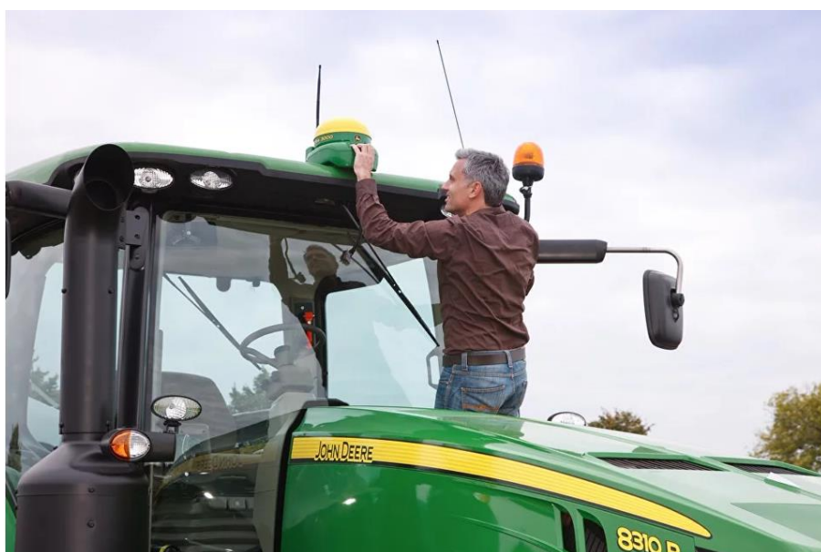
2.8-rasm. Traktorlarni GPS qurilmalari bilan jihozlash
