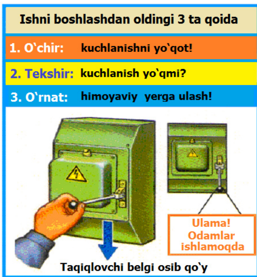
4.22 – rasm. Ishni boshlashdan oldin elektr xavfsizligini ta'minlash tadbirlari.
