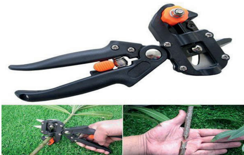
17-расм. Қишки пайвандлаш махсус пайвандлаш қайчи билан ускуна пайвандлаш жараёни
