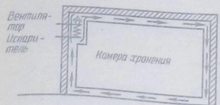
Рис. 23. Схема «кожухового» охлаждения камеры холодильника.
